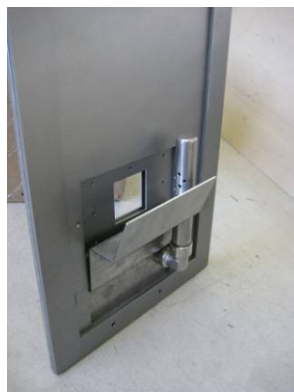
Vue intérieure avec bac de récupération et mandrin à buse pneumatique
